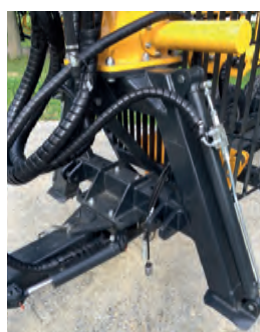
Dreipunktkran mit Teleskopstützfüssen Opt. Schwenkeichsel
