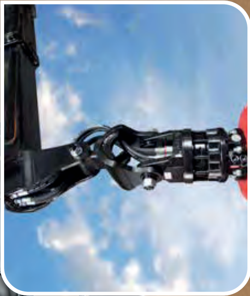
Kreuzgehänge mit innenliegenden Schläuchen
