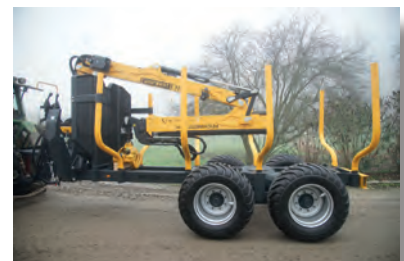
17 t-Hänger mit 550/45-22.5 Bereifung und 8-Lochfelgen
