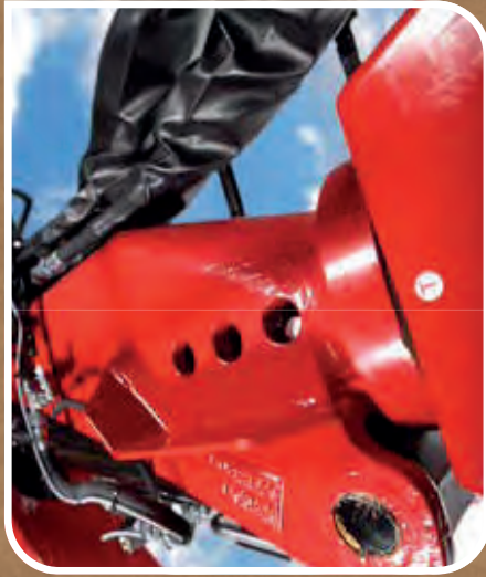
Kran ohne Drehverteiler
