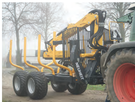
Starke Klappstützfüsse, Abstützbreite 352 cm
