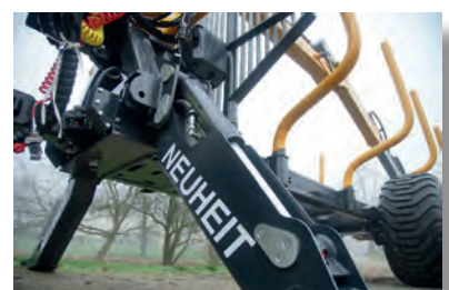
Starke Klappstützfüsse, Abstützbreite 352 cm
