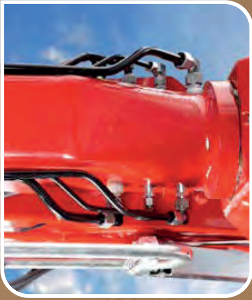
Kran mit Drehverteiler
